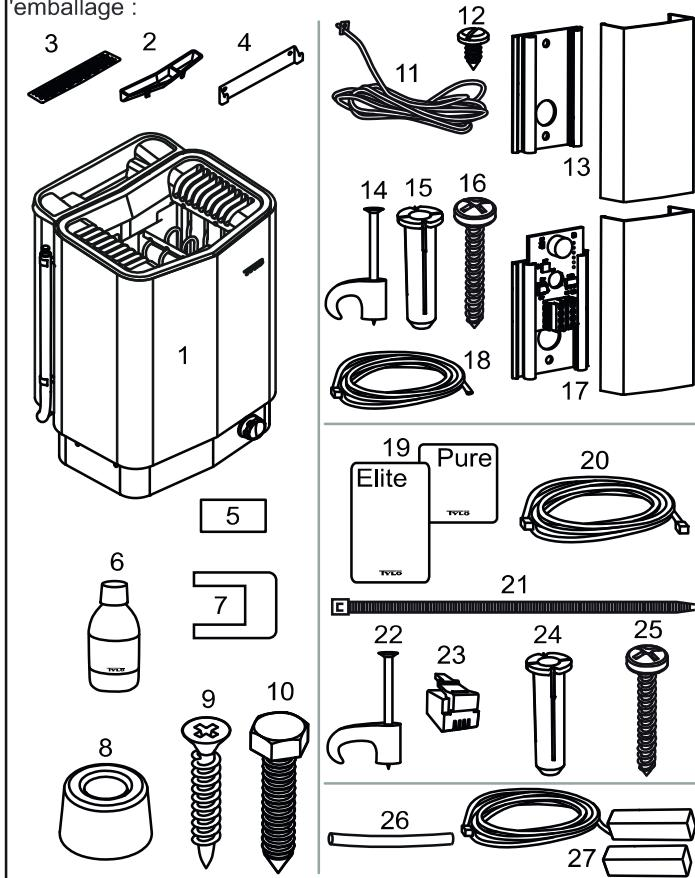
Figure 1 : Éléments du poêle de sauna/panneau de commande
