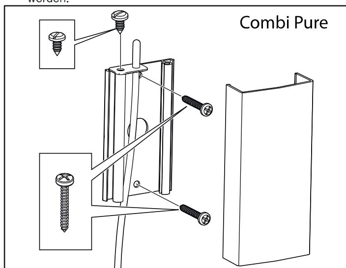
Abbildung 14: Installation des Sensors - Combi Pure
