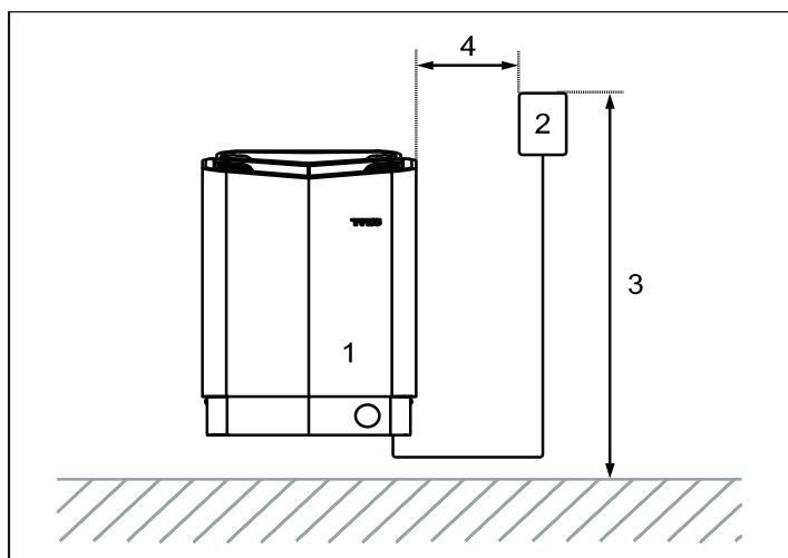
Afbilding 6: Veilige afstand/montagehoogte bedieningspaneel
