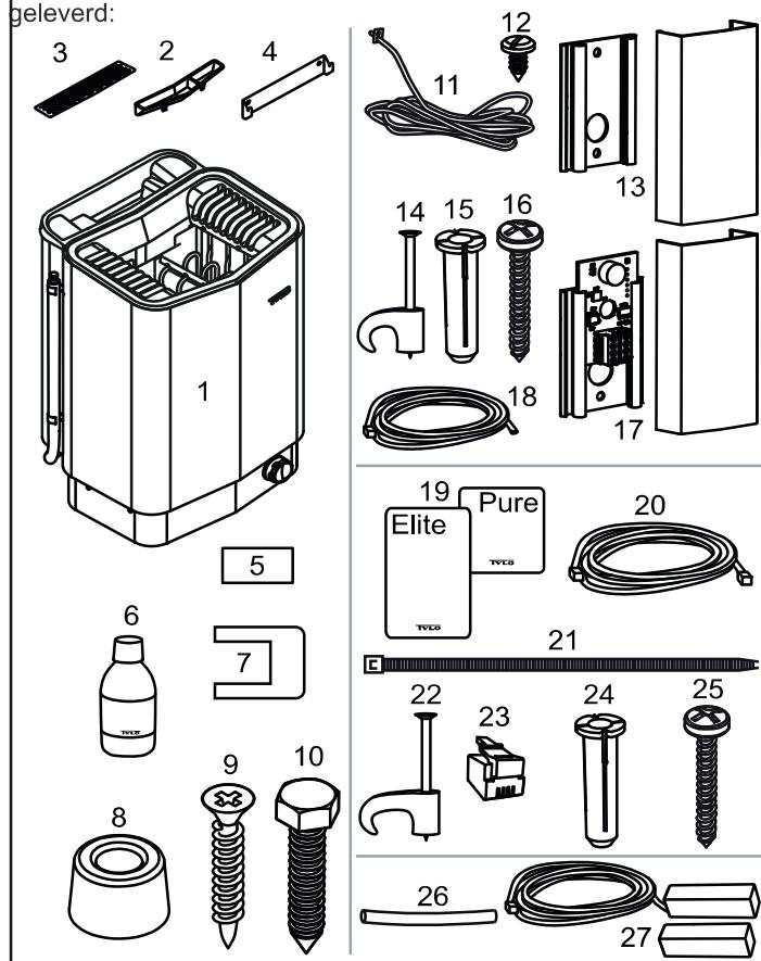
Afbeelding 1: Onderdelen van de saunakachel en het bedieningspaneel
