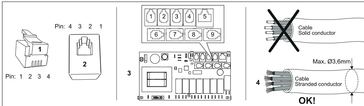
Rysunek 20. Wtyk modularny / złącze modularne, płytka przekaźników wysokiego napięcia i przewód wielożyłowy
