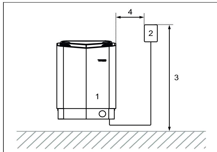
Rysunek 6. Bezpieczne odstępy/wysokość montażu od panelu sterowania
