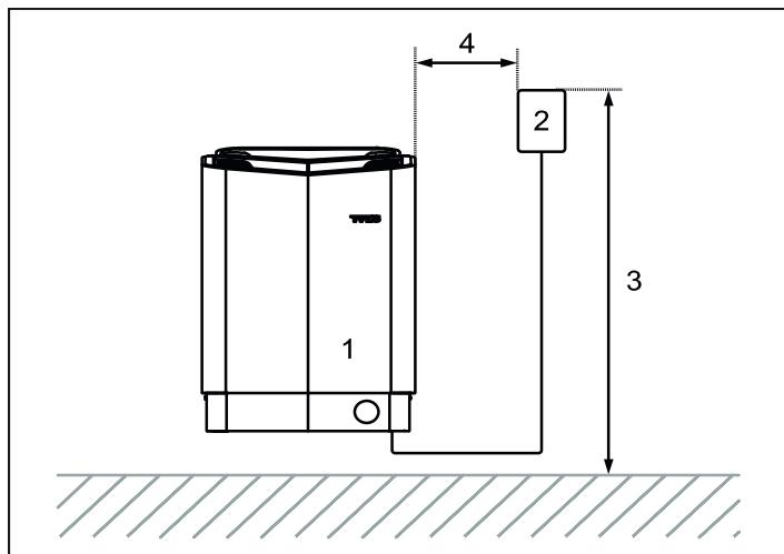
Рисунок 6: Безопасное расстояние/Высота установки до панели управления
