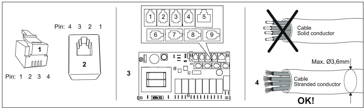
Afbeelding 21. Modulaire plug/modulaire stekker "high" en meerdradige kabel
