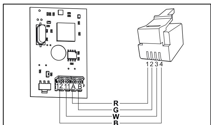
Fig 18: Inkoppling av fukt- och tempsensor - Combi Elite
