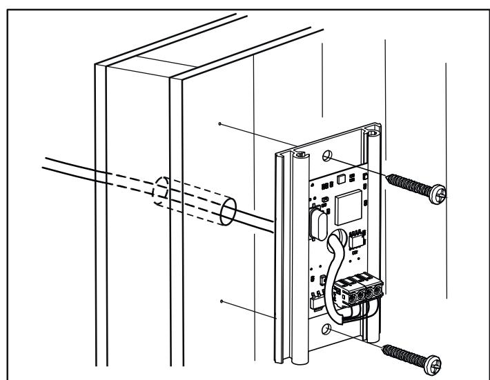
Abbildung 16B: Kabelführung durch die Wand. Das Beispiel zeigt den Sensor für Combi Elite. Verbinden Sie das Sensorkabel (siehe Abbildung 18).
