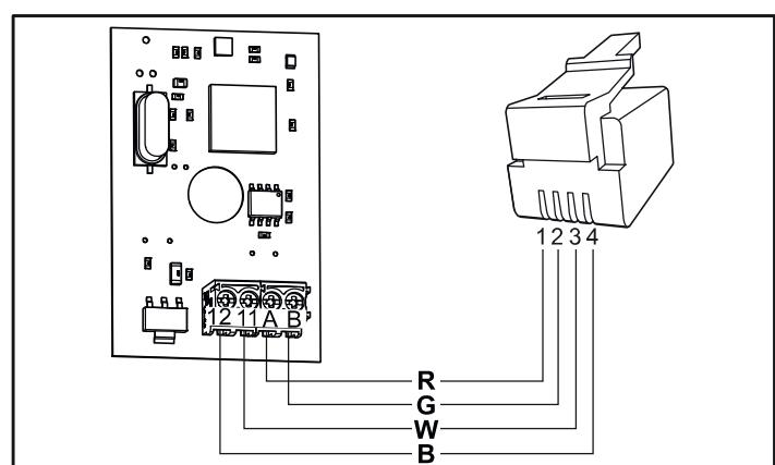
Abb. 18: Anschließen des Feuchtigkeits- und Temperaturfühlers - Combi Elite
