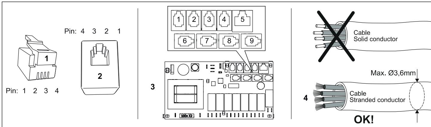
Fig. 21 Modularplugg/modularkontakt, reläkort "high" och ledare flertrådig
