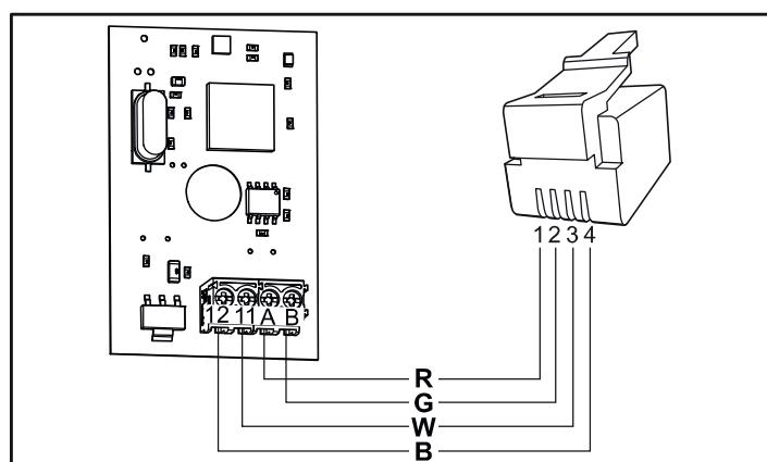
Рис. 18: Подключение датчика температуры и влажности - Combi Elite
