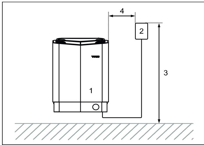
Fig 6: Säkerhetsavstånd/monteringshöjd manöverpanel
