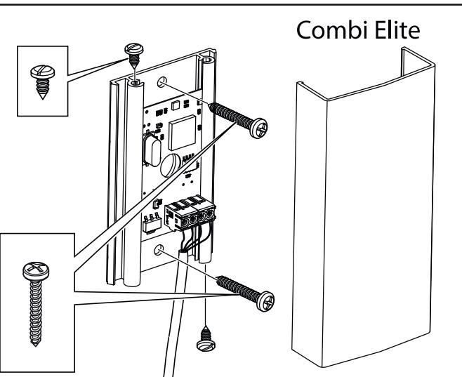
Рис 15: Установка датчика температуры и влажности - Combi Elite Кабель внутри кабеля должен быть термостойким. Подключите кабель датчика (см. Рисунок 18).
