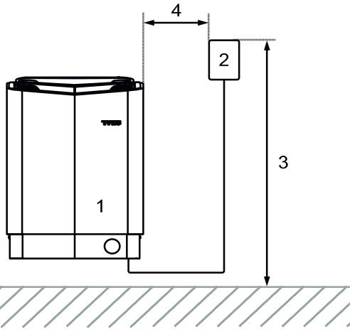
Abbildung 6: Sicherheitsabstand / Montagehöhe Steuerung
