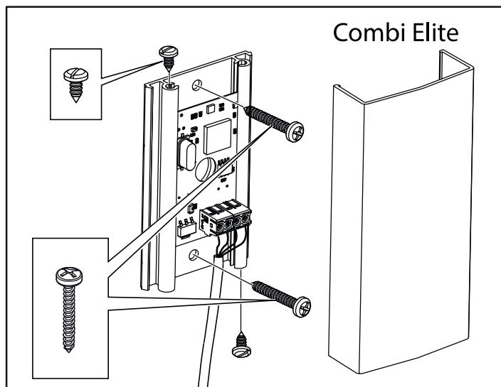
Abbildung 15: Installieren des Feuchtigkeits- und Temperaturfühlers - Combi Elite. Das Kabel in der Sauna muss hitzebeständig sein. Verbinden Sie das Sensorkabel (siehe Abbildung 18).
