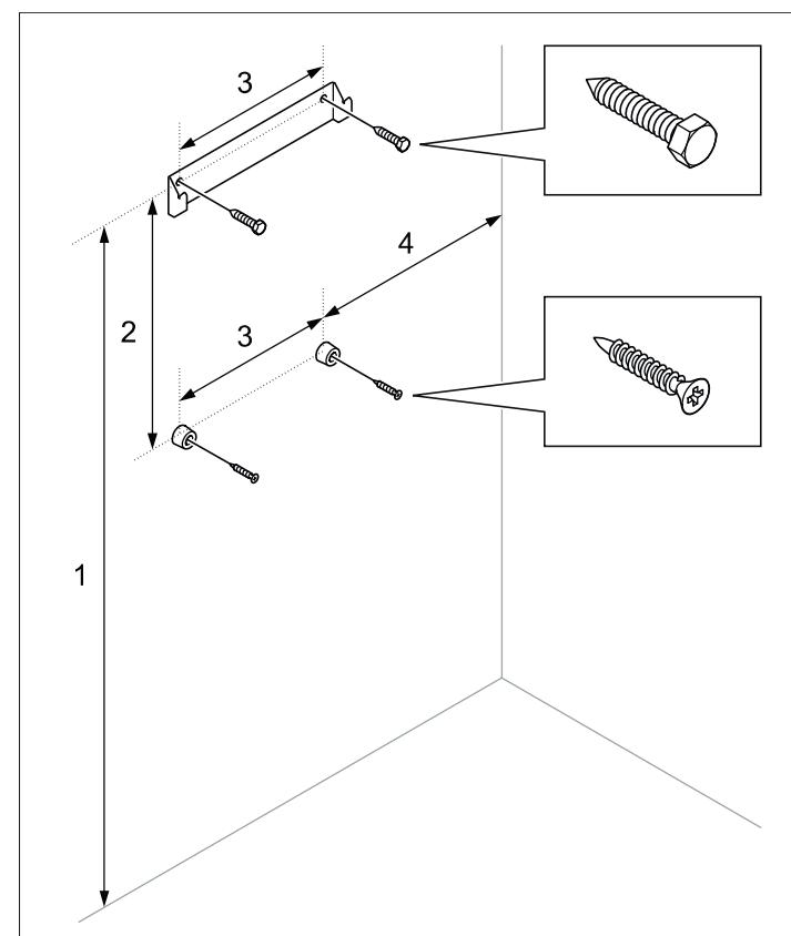
Rysunek 8. Wspornik z wkrętami i elementami dystansowymi
