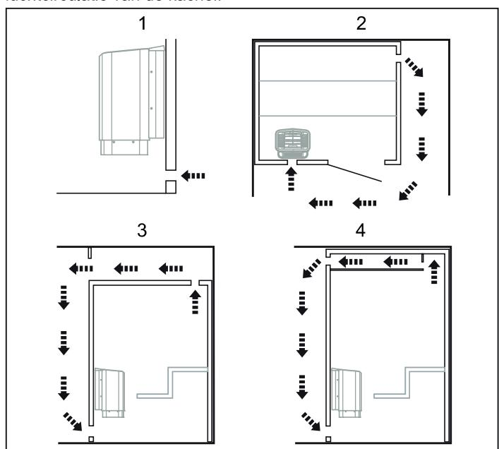
Afbilding 7: De luchtinlaat- en luchtoutlaatopening aanbrengen
