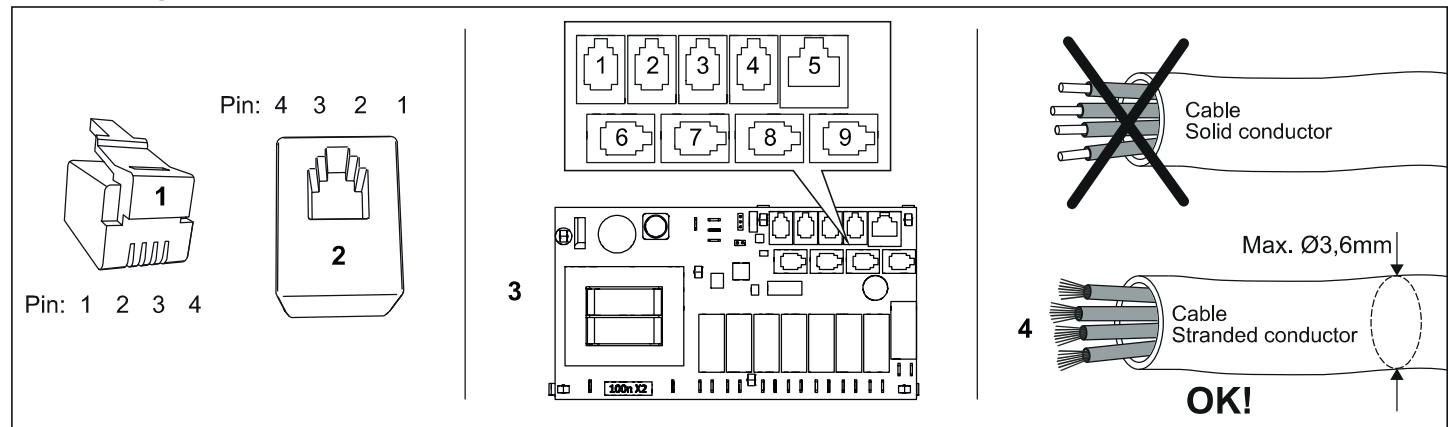
Abb. 21. Modularer Stecker/Modularer Kontakt, Relaiskarte „High“ und mehradriger Leiter
