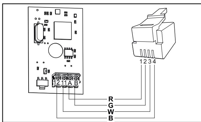
Rysunek 18. Podłączanie czujnika temperatury / wilgotności — Combi Elite
