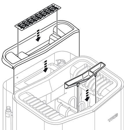
Рис 13: Установка крышки для резервуара для воды, решетки для трав и держателя для ароматизатора/увлажнителя воздуха
